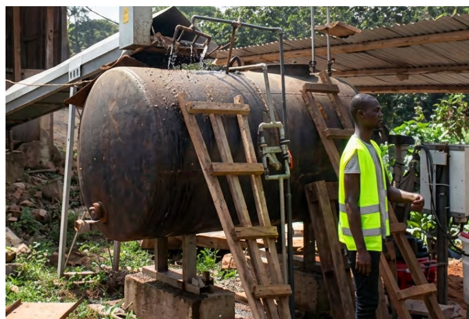
Dispositif de prétraitement des fientes de poule produites hors sol
